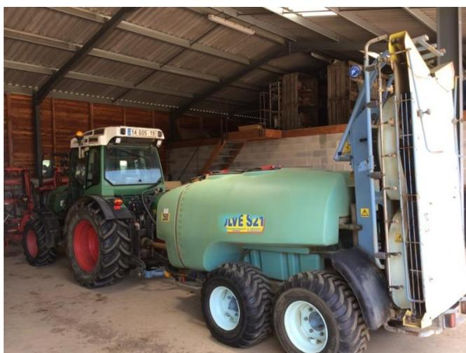
Figure 17 : Atomiseur à jet porté, double turbine verticale
